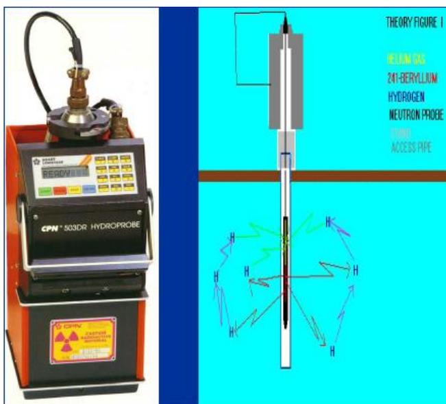
A sonda deve ser cuidadosamente ---calibrada para cada tipo de solo e para as diferentes camadas.
