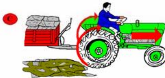
A BLOCAGEM DESLIGA-SE DEIXANDO DE ACTUAR NO PEDAL LOGO QUE DEIXE DE SER NECESSÁRIA, OU AUTOMATICAMENTE
