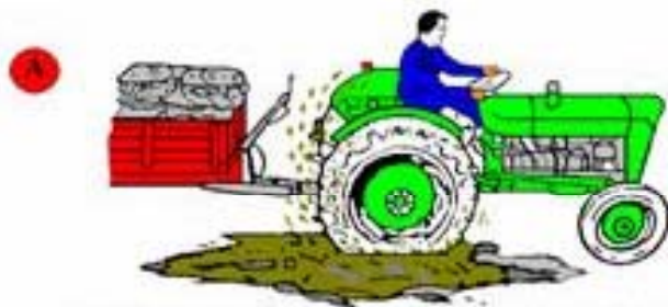
QUANDO UMA DAS RODAS PATINA CARREGA-SE NO PEDAL DO BLOQUEIO
