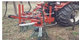
Fig. 4 - Alfaia para despampar ou desladroar.
